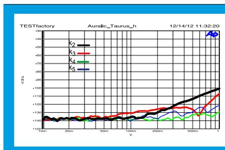
Der Frequenzgang (o. Abbildung) des Auralic Taurus zeigt sich extrem breitbandig. Die Harmonischen-Analyse (Abbildung) lässt auch kaum Meckereien zu: Bis 100mV so gut wie kein Klirr, dann mit k2 sanft ansteigend, k3 (rot) etwas unruhiger. Die Störabstände sind bei XLR und Cinch mit 102 und 107dB ganz ausgezeichnet. Verbrauch Standby/ Betrieb: 0,6 / 18,5W.
