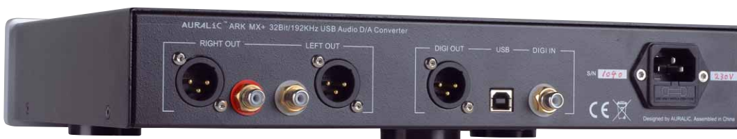
Analog geht's wahlweise symmetrisch oder asymmetrisch an die Vorstufe, intern laufen diese beiden Zweige komplett getrennt
