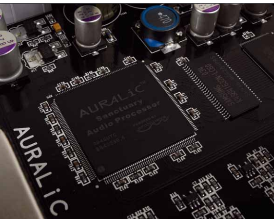
Der ARM9-Prozessor übernimmt Upsampling, Codieren und Entzittern
