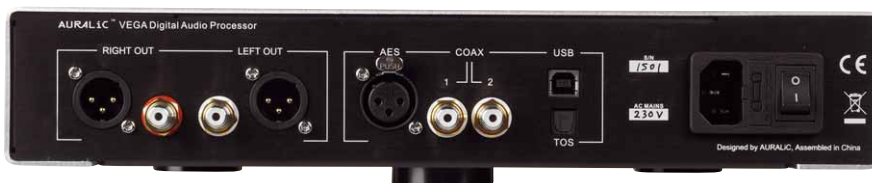
Digitale Eingänge aller Art sind vorhanden, die extrem breitbandige USB-Anbindung ist eines der Highlights
