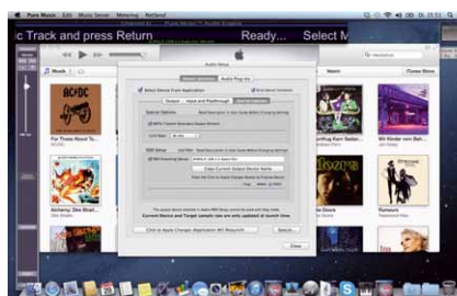
Das DSD-Streaming wird im Menü „Audio Setup“ unter „Special Options“ aktiviert
